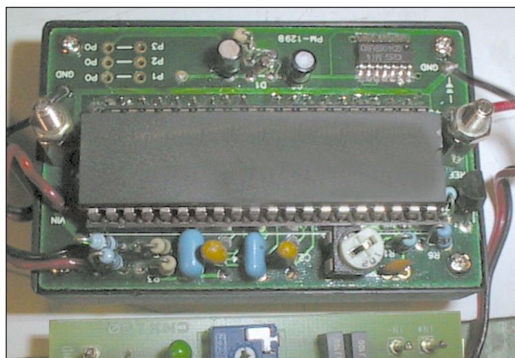
Detaliu amplasare componente panelmetru PM129-B
