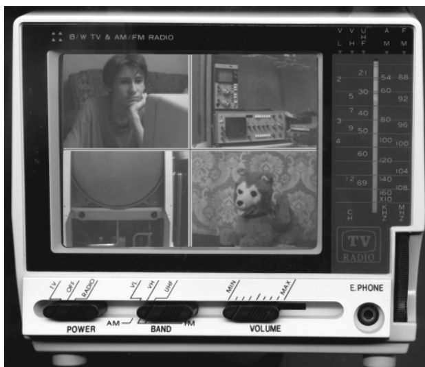
Fig. 4 Semnal provenit de la 4 camere video printr-un quad (vezi text)
