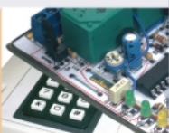
CENTRALĂ DE ALARMĂ LA EFRACTIE ȘI INCENDIU
