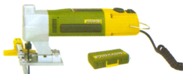
Fierăstrău SS220/E Cod 28530 • 1 000...4 000vibrații/min • Alimentare la 220V ca • Lungime 230mm
