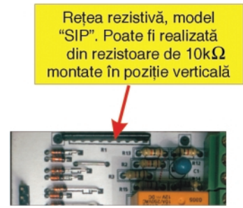
Fig. 4 Rețeaua rezistivă (10kΩ) în capsulă SIP
