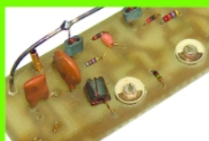
Amplificator de bandă largă, VHF-UHF
