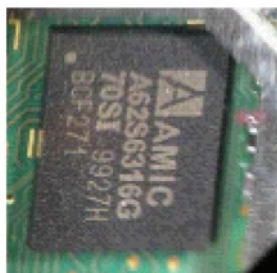
Fig. 14 Aspectul componentei D302: SRAM - AMIC
