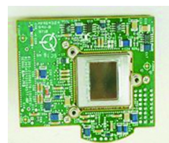
Fig. 5 Captarea radiației IR incidente a) Radiație incidentă și celulă de detecție (microbolometru); b) Structura unei celule de detecție; c) Încapsularea ariei de detecție IR și integrarea sa în cadrul unui modul electronic specializat
