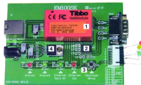
Fig. 5 Placa de evaluare EM100SK, elemente constitutive (1 - modul EM100, 2 - MAX232, 3 - LTC1232 pentru reset, 4 - regulator 7805)
