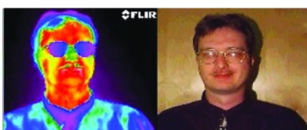
Fig. 4 Termogramă vs. fotogramă (fotografie)
